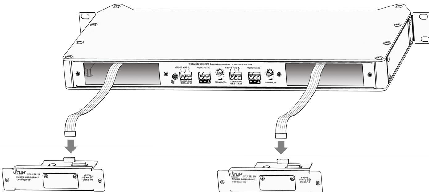
1. Снимите заглушку с задней панели, открутив два винта крепления заглушки отверткой с крестообразным шлицем (PH1).
